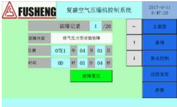
图 10-7 故障记录显示界面
