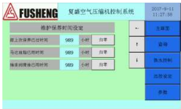
图 10.14(b) 维护保养时间设定界面
