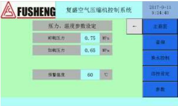
图 10.3 压力温度参数设定界面
