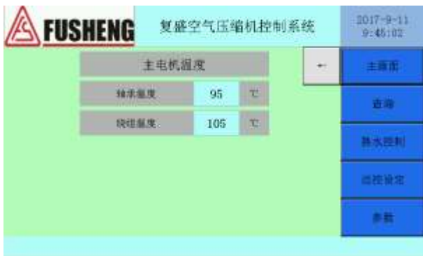
图 10.6 主电机温度显示界面
