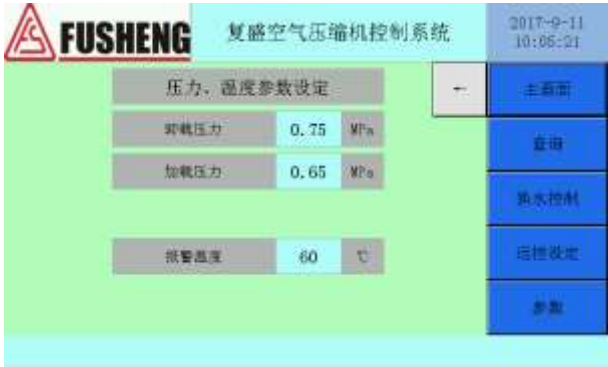
图 10.12 压力温度参数设定界面
