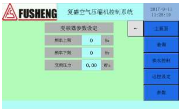
图 10.15 变频器参数设定界面
