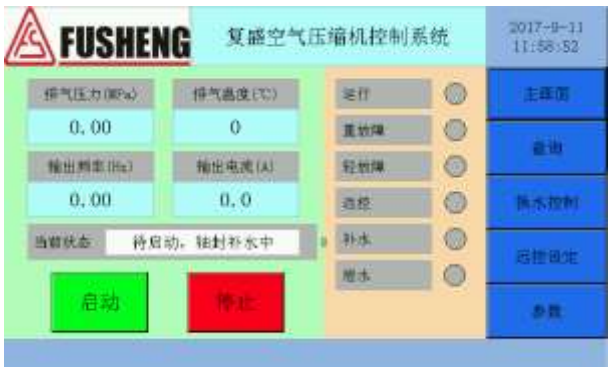
图 10.21 机组启动前轴封预补水界面
