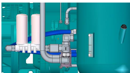
图39：取下油过滤器
